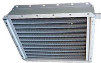
Калориферы имеют теплоотдающие трубки  $Dn16 \times (1,5 \div 2,8)$  мм с оребрением стальной лентой толщиной 0,5 мм.
