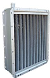
Калориферы имеют теплоотдающие трубки  $Dn16 \times (1,5 \div 2,8)$  мм с оребрением стальной лентой толщиной 0,5 мм.
