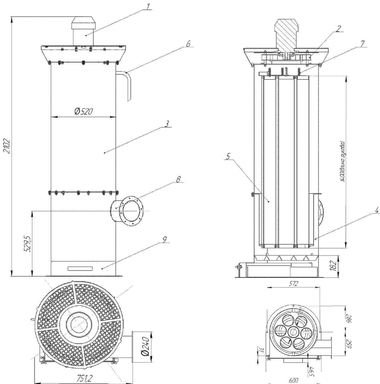
1 – электродвигатель; 2 – вентилятор (р.к.); 3 – корпус; 4 – фильтр грубой очистки; 5 – фильтр тонкой очистки (пулав); 6 – рукоятка встряхивающего механизма; 7 – встряхивающий механизм; 8 – присоединительный патрубок; 9 – бункер с совком
